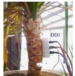
Rechts: So sieht es aus, wenn die Heiznadel und die Temperatursensoren an der Pflanze angebracht sind. DC1 steht für Dracaena cinnabari und DD1 für Dracaena draco . Bilder: Nadezhda Nadezhdina.
